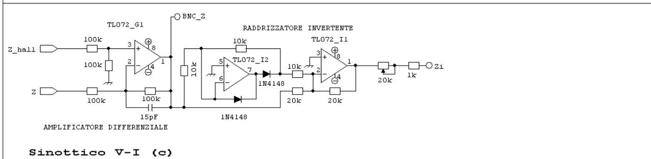
Per quel che riguarda il sensore ad effetto Hall la scelta è caduta sul trasduttore raziometrico siglato "SS49E" della Honeywell, con questo circuito si riesce a rilevare campi magnetici di intensità massima 1000 Gauss e tempo di impulso minimo 3uS, con sensibilità nominale di 1.4 mV/Gauss.
