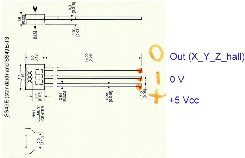
I tre sensori (X-Y-Z) sono stati saldati ad un cavo di collegamento (piattina 5 poli), isolati elettricamente ed inseriti all'apice di un tubo quadrato di alluminio 10x10mm, come da immagini allegate.
